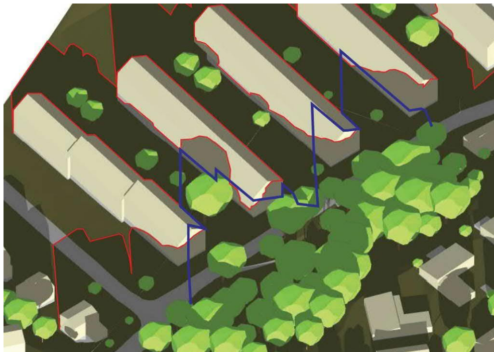
Röd linje- skuggor kl 16 från träd och befintliga byggnader innan utbyggnad Blå linje - skuggor kl 16 från nya och befintliga byggnader efter utbyggnad
