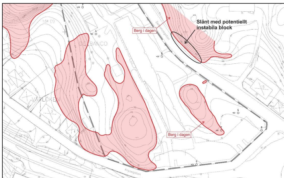
Figur 6.1 Förekomster av blottat berg (inklusive berg med tunt jordtäckte, < 0,5 m; röda markeringar) i planområdets södra del, samt läget för en bergslänt med potentiellt instabila block öster om Delbancogatan.
