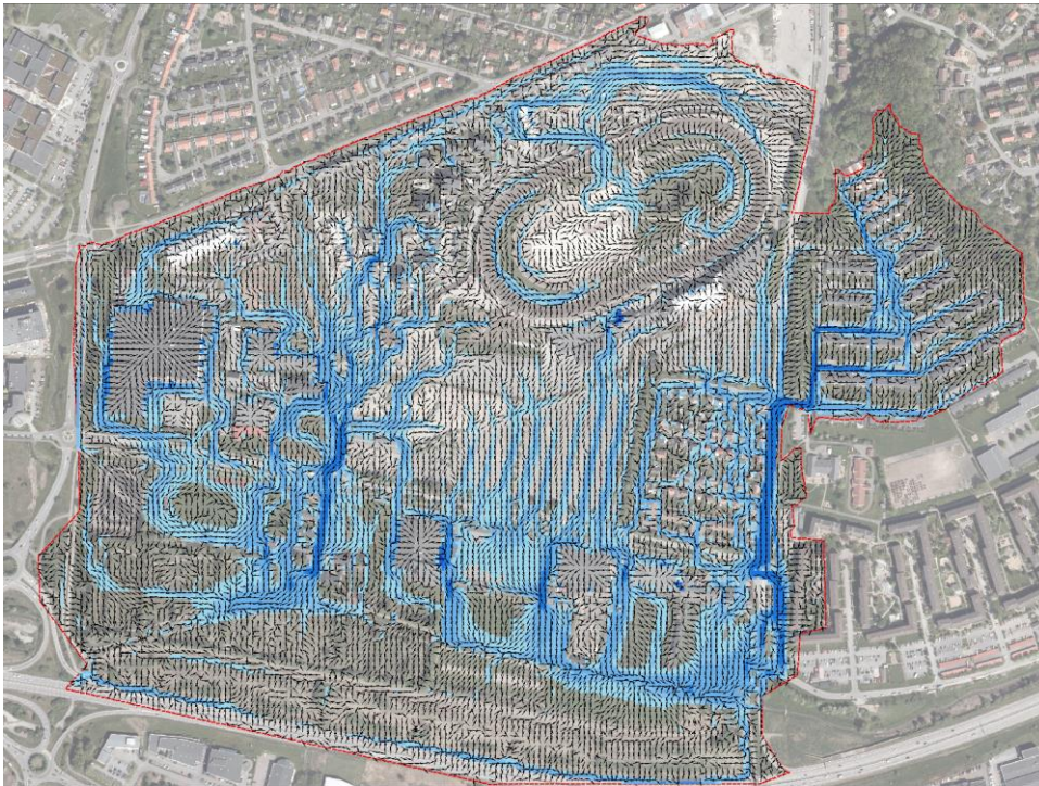
Figur: Modellberäknad flödesavledning vid ett klimatanpassat 100-årsregn inom avrinningsområde kv. Hälsan m. fl.
